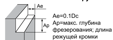
Рис.3 Фрезерование уступа с большим вылетом инструмента
