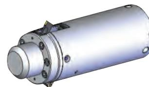
Использование технологии глубокого сверления позволяет получать отверстия при сверлении с точностью IT10 и шероховатостью Ra от 3,2 до 1,6 мкм.
