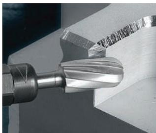
Гравировальные резцы из твердых сплавов и быстрорежущей стали
