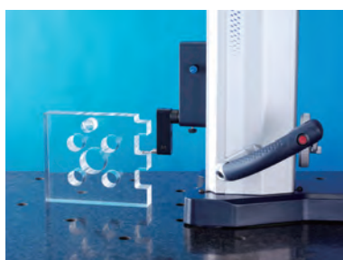
Пример применения QM-Height в плавающей воздушной подвеске
